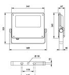
Scheda tecnica Philips Proiettore LED Coreline BVP125 Grigio 95W 12000lm 9-41x102D - 740 Bianco Freddo | IP66 - Asimmetrico
