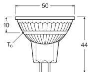
Scheda tecnica Ledvance Faretti LED GU5.3 MR16 3.8W 350lm 36D - 830 Luce Calda | Sostitutiva 35W
