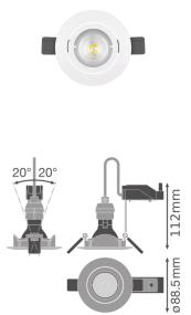
Scheda tecnica Ledvance Faretti LED Kit Inclinabile GU10 PAR16 8.3W 520lm 36D - 930 Luce Calda | Miglior resa cromatica - Dimmerabile - Sostitutiva 65W
