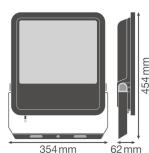
**Scheda tecnica Ledvance Proiettore LED GEN 3 Nero 200W 22000lm 100D - 830 Luce Calda | IP65 - Simmetrico**
