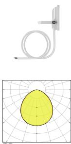
**Scheda tecnica Ledvance Proiettore LED GEN 3 Bianca 50W 6000lm 100D - 865 Luce del Giorno | IP65 - Simmetrico - Sostitutiva 100W**
